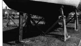
Sådan står båden i stativet. Sikker og forsikringsmæssigt korrekt, fordi bukkene er parvis forbundet.
